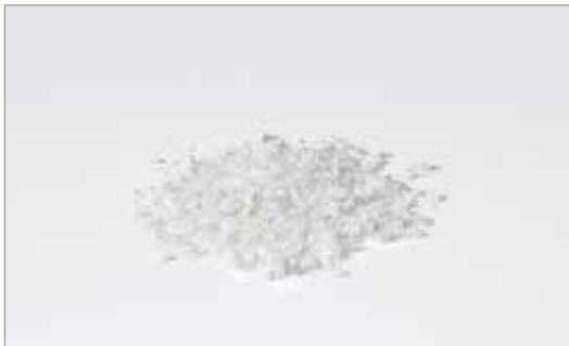
SIC nature graft b Granulat, Partikelgrößen 1,0–2,0 mm
